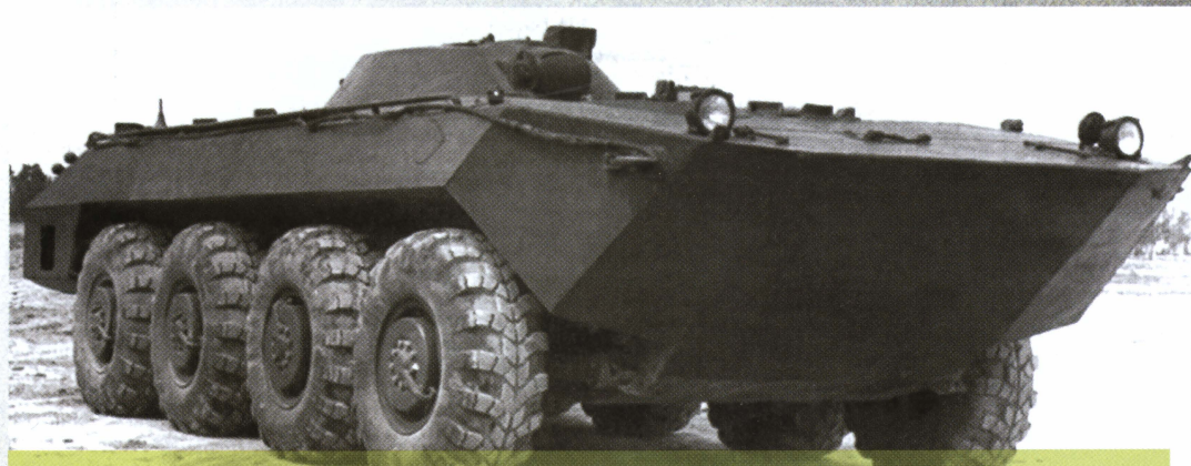
Колесная БМП Брянского автозавода «объект 1200». Вооружение в башне не установлено.
