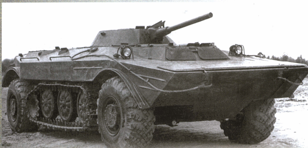
«Объект 19» — БМП на оригинальном колесно-гусеничном шасси, разработанном конструкторами Алтайского тракторного завода совместно с инженерами Военной академии бронетанковых войск.
